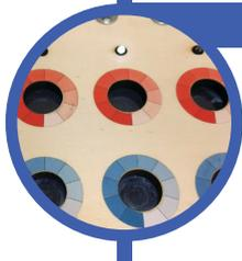
Die LEDs zeigen an, welcher Takt gerade der aktuelle Takt an. Es leuchtet immer nur eine Licht, welches alle 1,5 Sekunden weiterspringt. Falls sich ein Klotz in dem Farbkreis an dem aktuellen Takt befindet, wird der Ton in entsprechender Tonhöhe gespielt.
