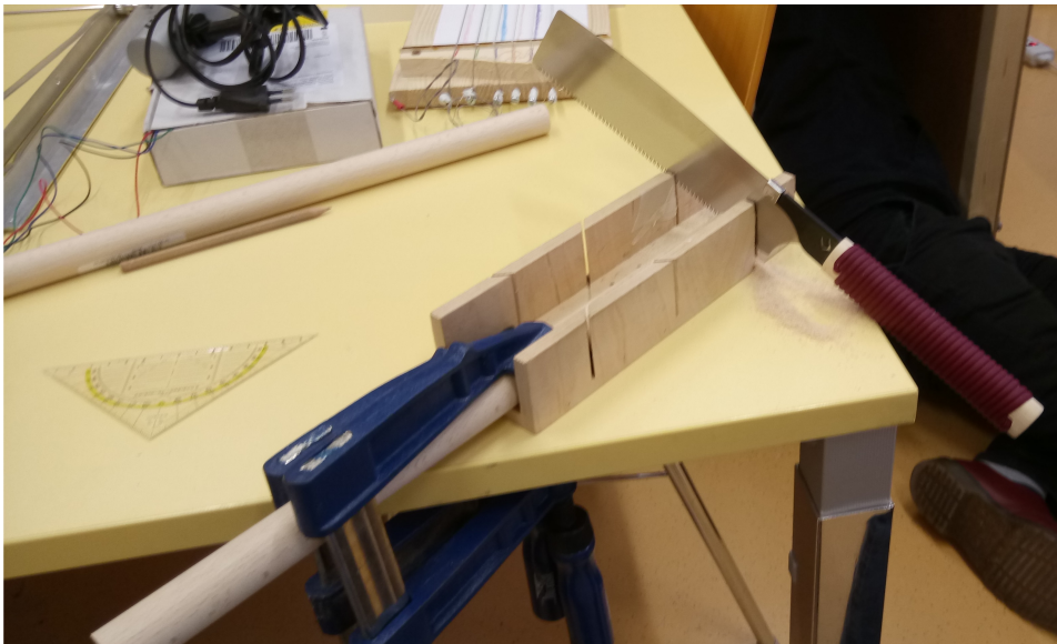
Abbildung 10: Fixierung der Holzstange und Schiene zur Unterstützung beim Sägen
