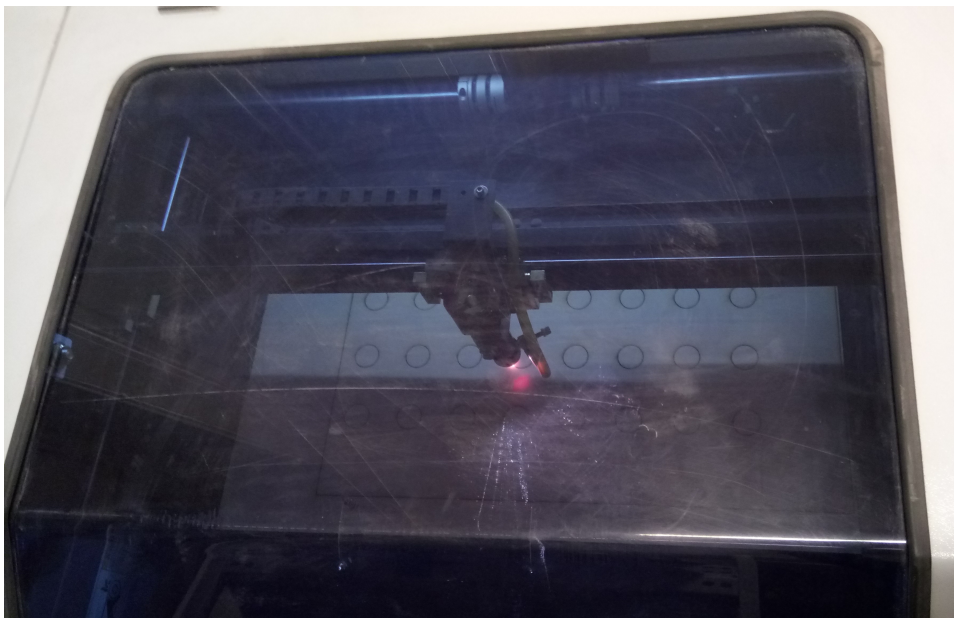
Abbildung 4: Lasercutter beim Ausnehmen der Steckplätze
